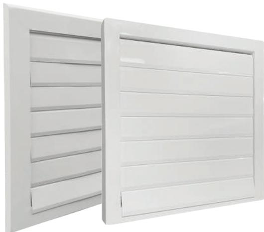
**Инерционная вентиляционная решетка ИВР1 (встроенная)** с горизонтальным расположением подвижных жалюзи предназначена для монтажа в составе вентиляционных систем. Используется как обратный воздушный клапан для автоматического перекрытия сечения воздуховода при выключении вентилятора. ИВР1 устанавливается в прямоугольные воздуховоды и подготовленные строительные проемы на фасадах зданий.
