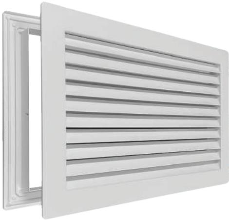
Переточная вентиляционная решетка ТВР с горизонтальным расположением нерегулируемых V-образных жалюзи используется в системах вентиляции и монтируется в дверной или стенной проем, межкомнатные перегородки для перераспределения (перетока) воздуха между помещениями.
