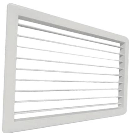
Внутренняя вентиляционная решетка ВВР1 с индивидуально регулируемыми поворотными жалюзи предназначена для обеспечения притока либо вытяжки воздуха в системах вентиляции, воздушного отопления и кондиционирования воздуха. Изделие формирует компактную, коническую или неполную веерную струю в зависимости от угла наклона жалюзи. Имеет один ряд горизонтальных (вдоль длинной стороны) поворотных жалюзи и регулирует направление потока вверх-вниз (при установке длинной стороной по горизонтали).
