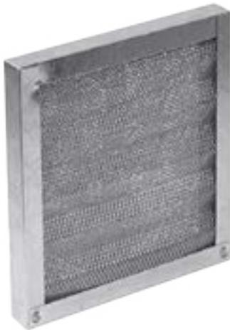
Фильтры воздушные ячейковые жиросушители ФВП предназначены для грубой очистки вытяжного воздуха от технологической пыли, масляных и жировых аэрозолей, удаляемых местными отсосами от кухонных плит в столовых, кафе, ресторанах, барах, а также вытяжной вентиляцией зданий и сооружений различных отраслей промышленности.
