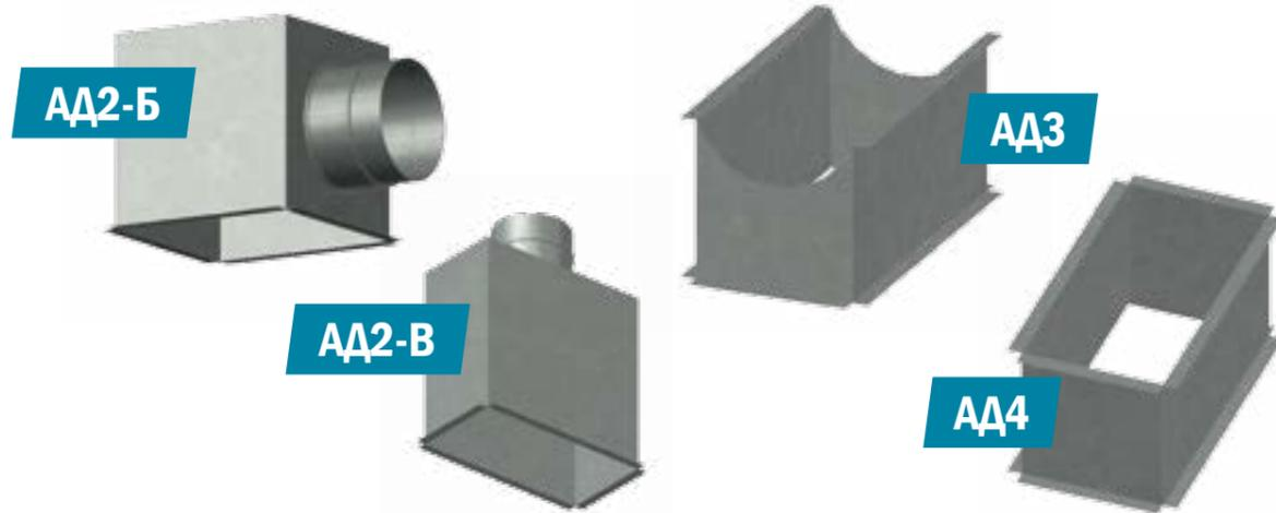
Адаптер для вентиляционной решётки (другое название – камера статического давления) используется как переход от воздуховода круглого, квадратного или прямоугольного сечения к вентиляционной решётке и выполняет две задачи: уменьшает перепад давления от вентиляционного канала к решётке, а также упрощает монтаж решётчатого изделия.
