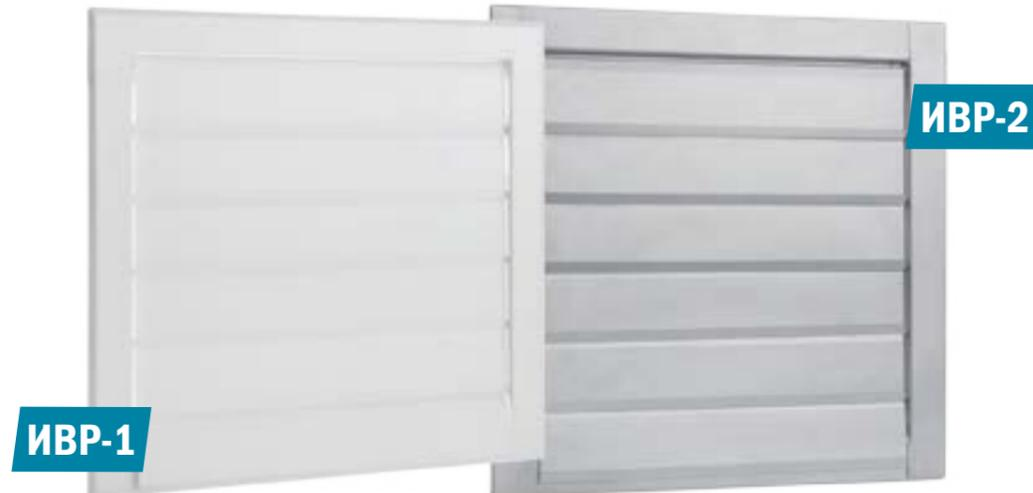
Инерционные решетки серии ИВР1 и ИВР2 с горизонтальным расположением подвижных жалюзи используются в системах приточно-вытяжной вентиляции и кондиционирования воздуха. Предназначены для монтажа в воздуховоды, строительные проемы и фасады зданий. Используются для удаления воздуха и автоматического перекрытия сечения воздуховода при выключенном вентиляторе.
