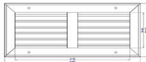
Перемычка устанавливается при размерах А>500 мм
